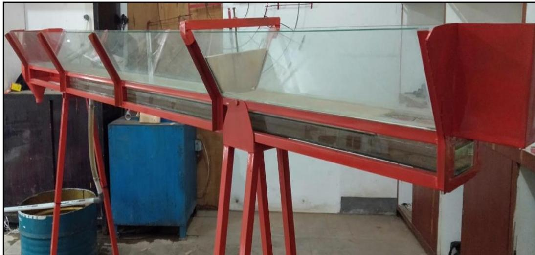
Gambar 2.1 Peralatan pengujian saluran terbuka model trapesium
