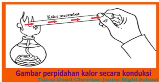
Gambar 1. perpindahan kalor secara konduksi
