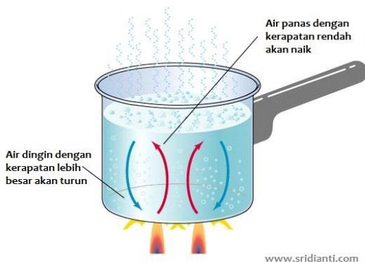
Gambar 2. perpindahan kalor secara konveksi
